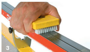
Abb. 3) Als letzten Schliff die Struktur mit einer weichen Polierbürste unter geringem Druck ausbürsten.
