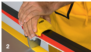
Abb. 2) Mit dosiertem Druck den Structurite Nordic 1- bis 2-mal über den Ski fahren. Wie viel Druck und Arbeitsdurchgänge nötig sind, hängt von der Belagsbeschaffenheit ab. Die Struktur muss fein im Belag sichtbar sein. Mehr Druck bedeutet eine ausgeprägtere Struktur, weniger eine Feinere.
