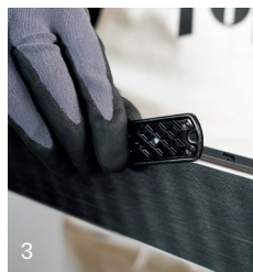
Remove burr with diamond files and sharpen edges Rimuovere le bave con lime diamantate e affilare le lamine
