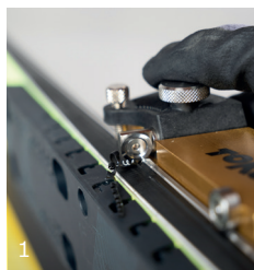
Remove sidewalls with sidewall planner Rimuovere i fianchi con il pianificatore di fianchi
