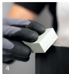
Round off ski ends to create a smooth transition Arrotondare le estremità degli sci per creare una transizione morbida
