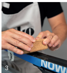
Mit Plasto Cork einkor-ken oder einbügeln Cork in with Plasto Cork or iron in
