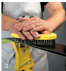
Abtrocknen lassen und mit Kupferbürste ausbürsten Let dry and brush out with a copper brush
