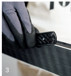
Grat mit Diamantfeilen entfernen und Kanten schärfen Remove burrs and sharpen edges using diamond files
