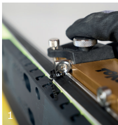
Seitenwangen mit Sidewall Planer abnehmen Remove sidewalls using a sidewall planer
