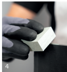
Skienden abrunden, um sanften Übergang herzustellen Round off ski tips and tails to ensure a smooth transition
