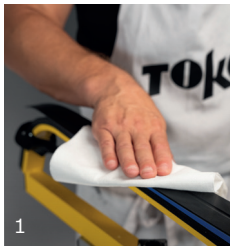
Reinigung des Skibehängs (optional) Cleaning the ski base (optional)
