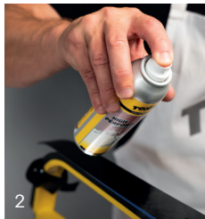
Liquid Paraffin aufsprühen und ca. 30 Minuten trocknen lassen Spray on liquid paraffin and let dry for approx. 30 minutes
