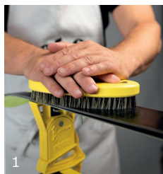
Reinigung mit Feinstahl- oder Kupferbürste Cleaning with a fine steel or copper brush
